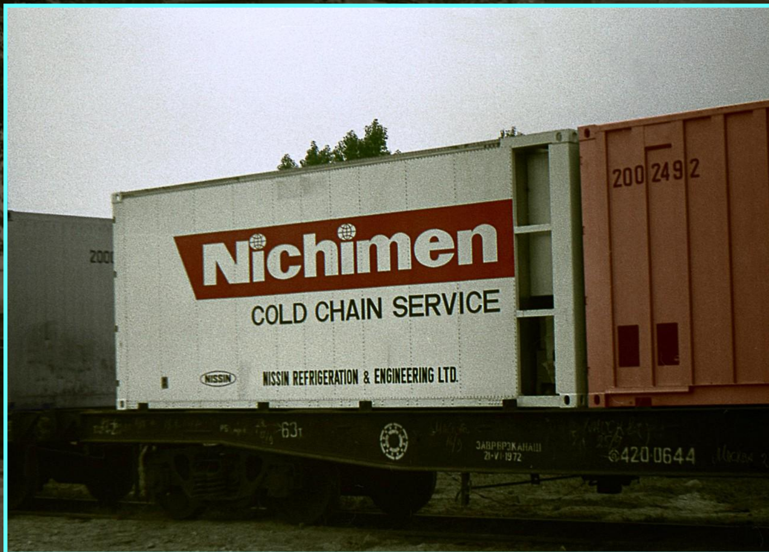
Рефрижераторный контейнер типа 1С массой брутто 20 т
