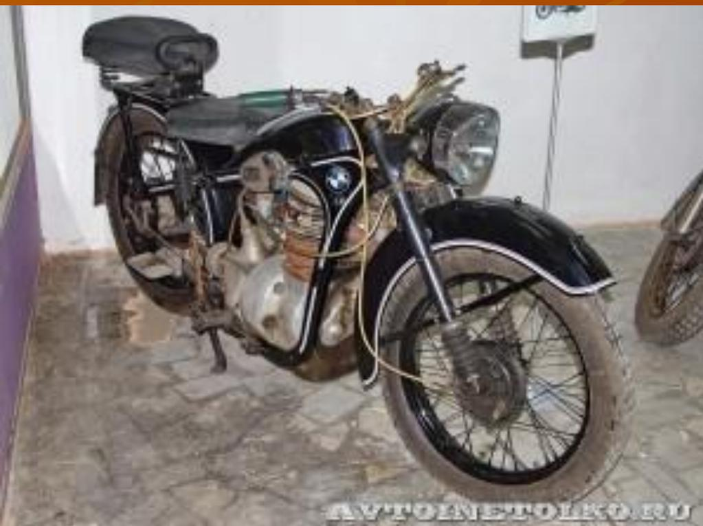
Выпускался с 1937 по 1940 год знаменитой баварской фирмой **BMW**. В годы войны широко использовался в пехотных подразделениях, полиции, медсанбатах. R-35 был основной двухколесной машиной Вермахта. Мотоцикл имел штампованную раму, одноцилиндровый двигатель объемом 340 см<sup>3</sup> мощностью 14 л.с. и выпускался с двумя типами передней подвески: рессорной и телескопической. После войны спрос на мотоцикл не уменьшился, и с 1945 по 1955 годы было произведено еще 80,000 машин.
