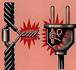
Поврежденная изоляция, неисправная электропроводка
