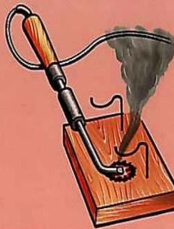
Отсутствие несгораемой подставки под электронагревательным прибором
