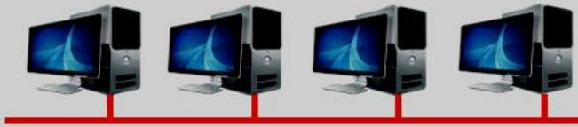
Используется один кабель вдоль которого подключены все компьютеры сети. Терминатор необходим для поглощения передаваемого сигнала на концах.
