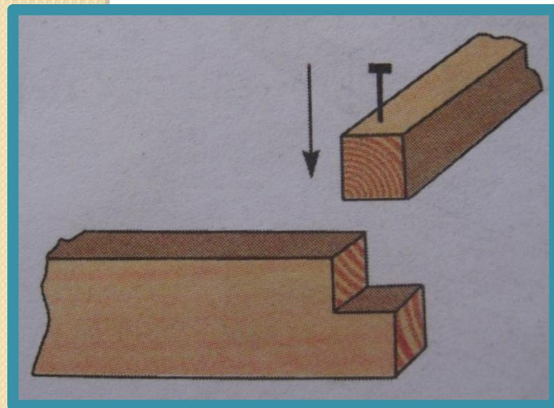
Одним из разновидностей соединения с запиливанием деталей применяют при изготовлении ящиков и т.д.
