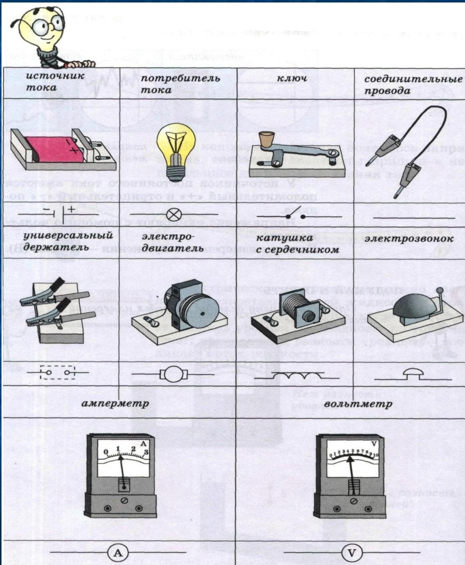
Для того чтобы использовать энергию электрического тока, нужно прежде всего иметь **источник тока**. Электродвигатели, лампы, плитки, всевозможные электробытовые приборы называют *приёмниками или потребителями электрической энергии*. Чтобы включить и выключить в нужное время приёмники электрической энергии, применяют *ключи, рубильники, выключатели*. Для доставки электрической энергии приёмник соединяют с источником *проводами*.
