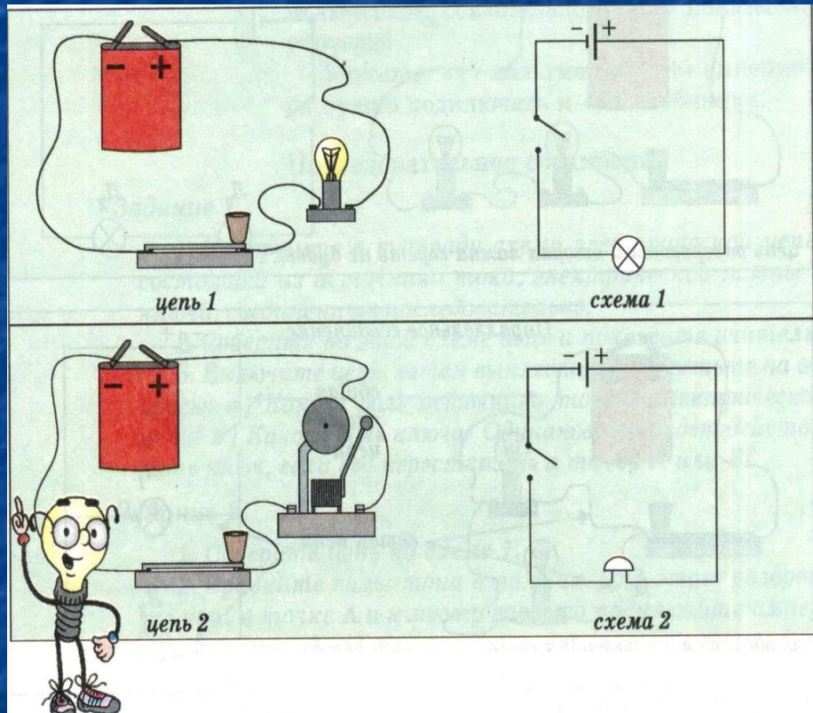
Источник тока, приемники, замыкающие устройства, соединенные между собой проводами, составляют *простейшую электрическую цепь*.
