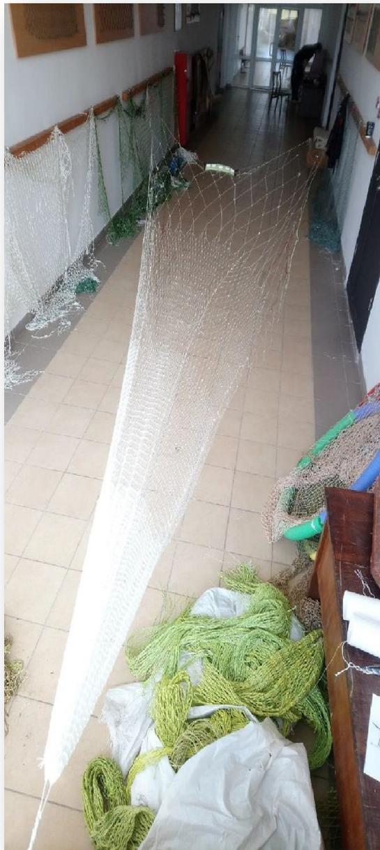
Рис 12 - Вид модели разноглубинного трала
