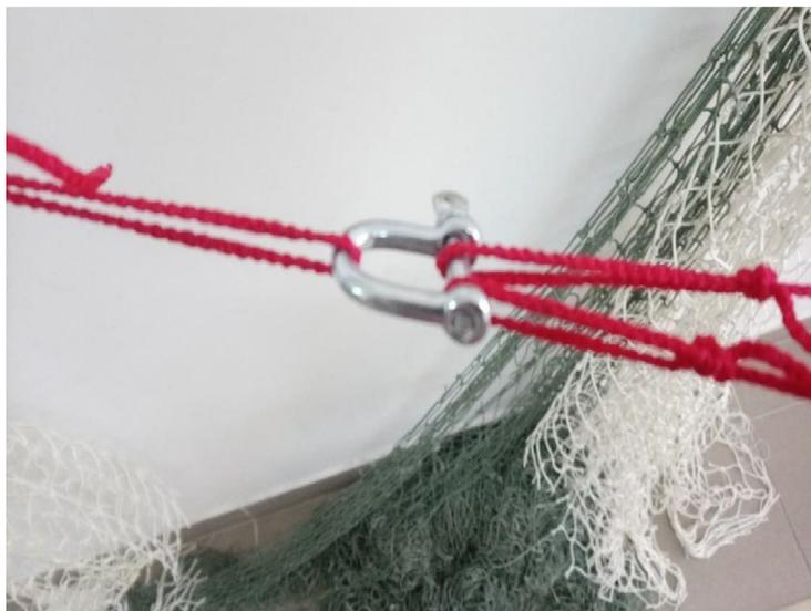
Рис 7 - Соединение скобой между голыми концами и кабелем (б)
