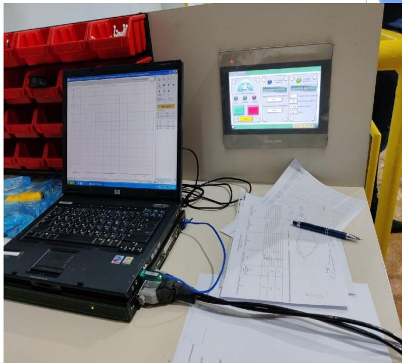
Рис 10 - тензометрическая аппаратура MIC-200
