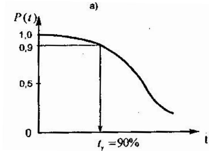
Рис. 2. Схема определения  $\gamma$  - процентного ресурса
