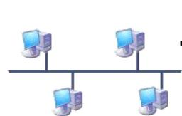
Топология типа Шина, представляет собой общий кабель (называемый шина или магистраль), к которому подсоединены все рабочие станции.
