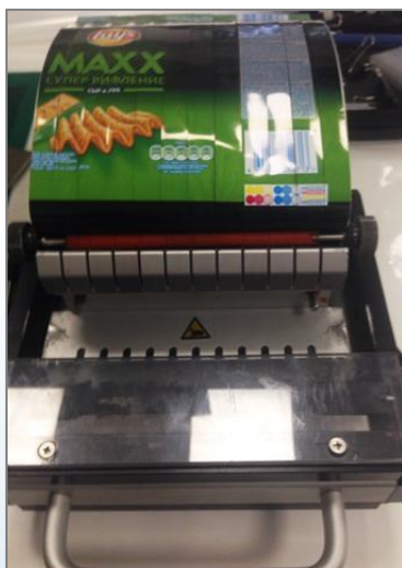
Вырубка образцов шириной 15 мм
