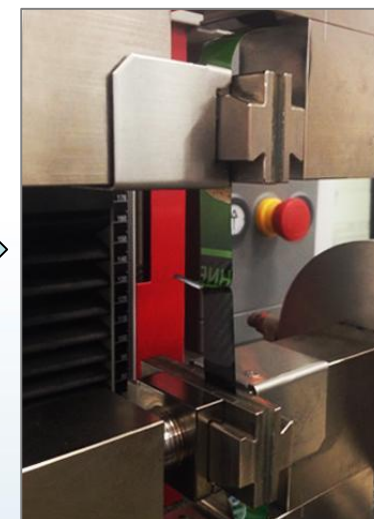
Испытание на прочность сварного шва, Н/15 мм
