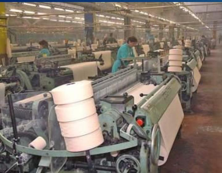
Ткань, снятая с ткацкого станка, содержит примеси и загрязнения, грязновато - серого цвета. Такую ткань называют **суровой**.
