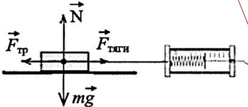
2)  $F_{\text{тяги}} = F_{\text{тр}}$  (при равномерном движении);
