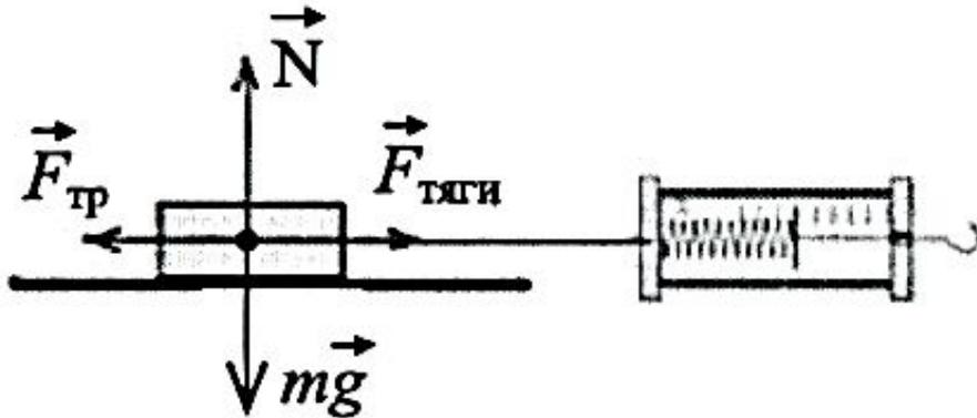
2)  $A = -F_{\text{тр}} \cdot s$ ;  $F_{\text{тр}} = F_{\text{тяги}}$  (при равномерном движении);
