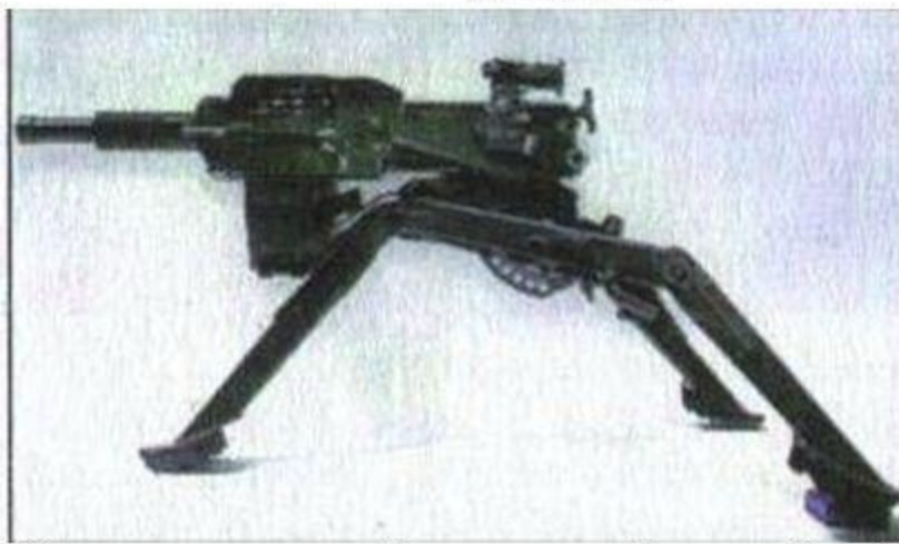
30-мм противопехотный автоматический гранатомётный комплекс АГС-17
