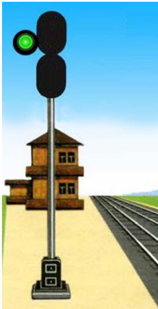
На железнодорожных станциях, где отправление поездов производится с железнодорожных путей, не имеющих достаточной длины, когда голова поезда находится за выходным (маршрутным) светофором, на его обратной стороне устанавливается повторительная головка, сигнализирующая зеленым огнем при открытом выходном (маршрутном) светофоре и свободности впереди двух и более блок-участков
