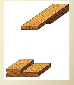
**5.** При угловом соединении на концах брусков торцы деталей делают немного
