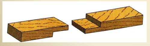
3. При соединении брусков вырезанными участками толщина получаемого изделия обычно
