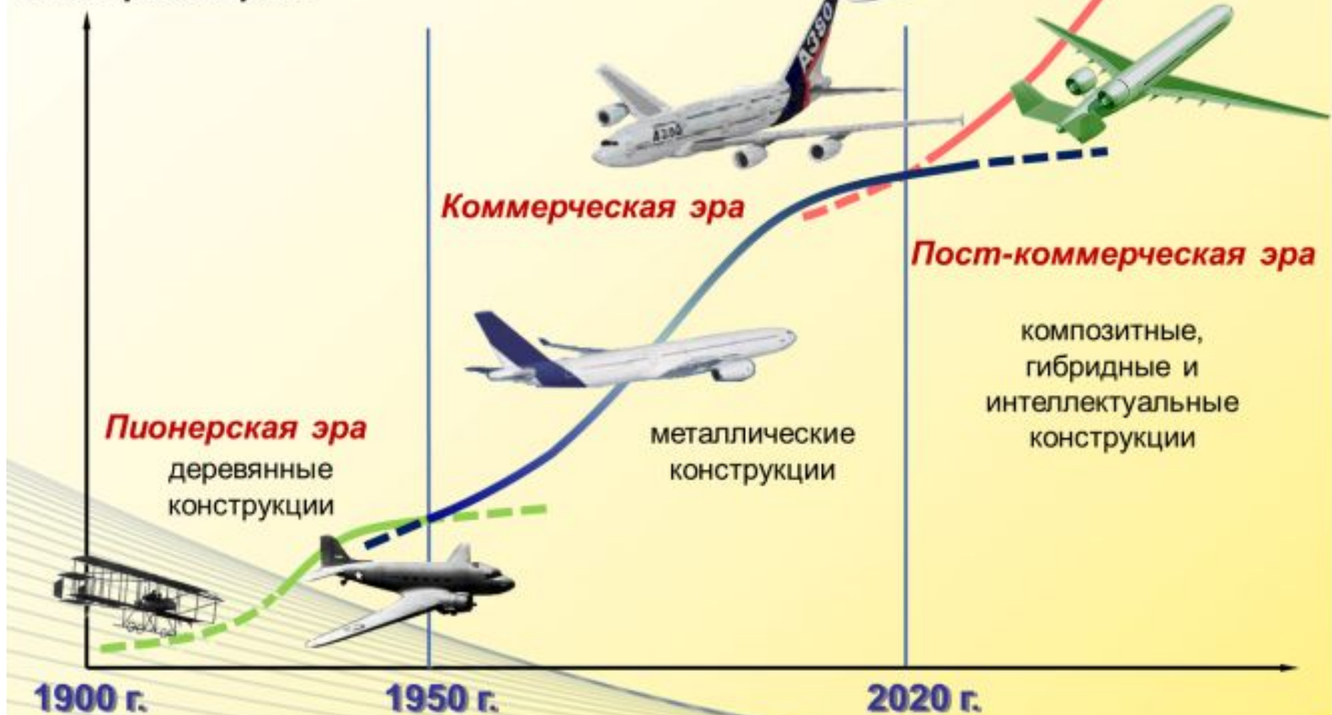
Рис. 1 Основные этапы развития компоновочных и конструктивно-силовых схем гражданских самолетов
