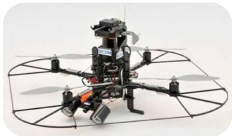
Квадрокоптер с защитой пропеллеров (вверху – GPS-модуль)
