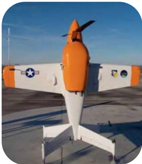
Тэйлситтер SkyTote (AeroVironment, США, 2006)
