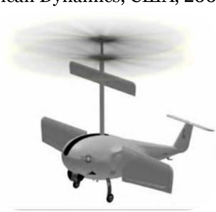
Spirit - БПЛА типа Freewing (Flight Technologies, США)
