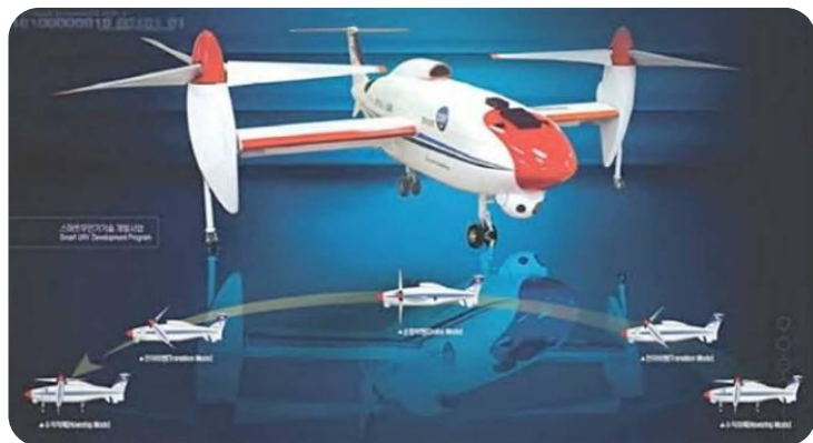
Smart с поворотными винтами типа Tiltrotor (Южная Корея, 2011)
