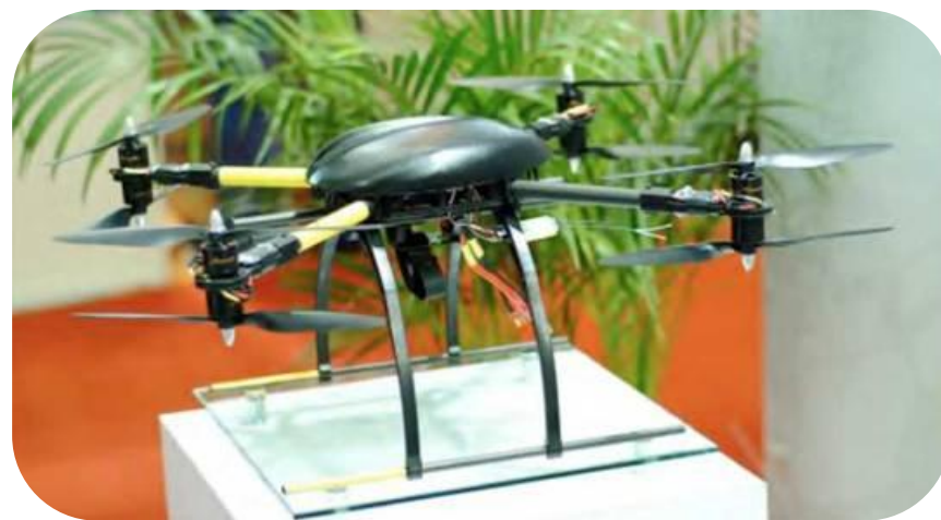
Квадрокоптер схемы «х» с совмещенными тянущими и толкающими винтами
