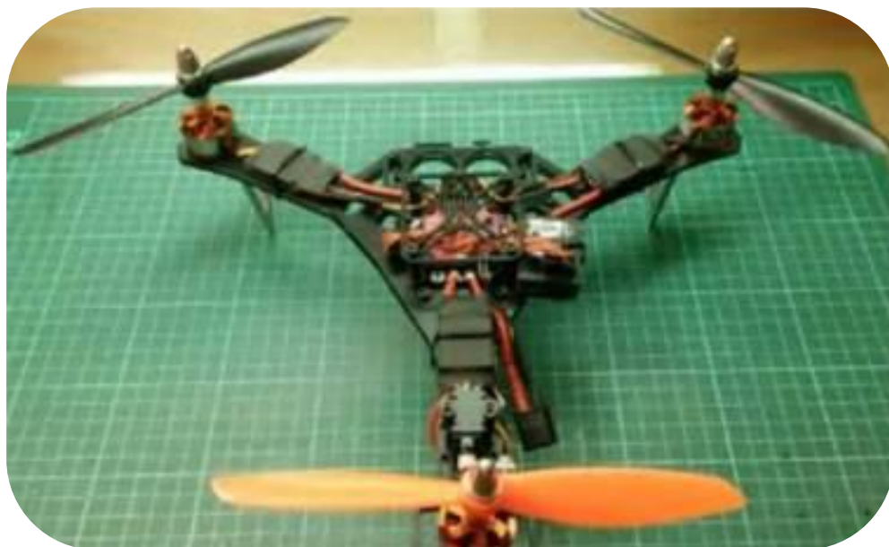
Трикоптер и сервопривод отклонения его хвостового ротора
