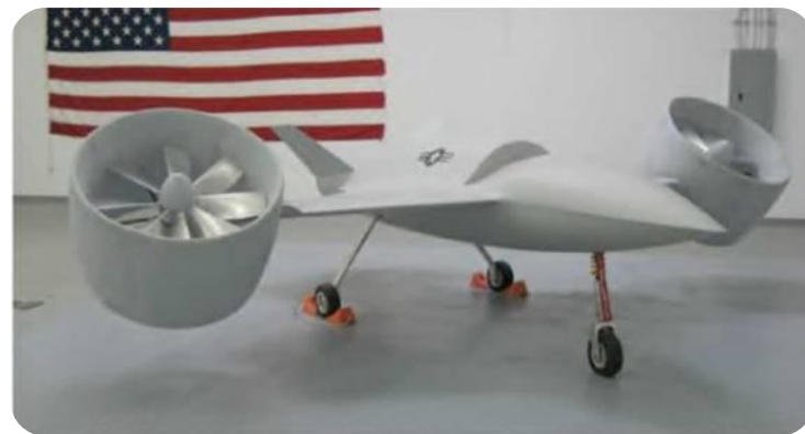
AD-150 с поворотными импеллерами (American Dynamics, США, 2008)
