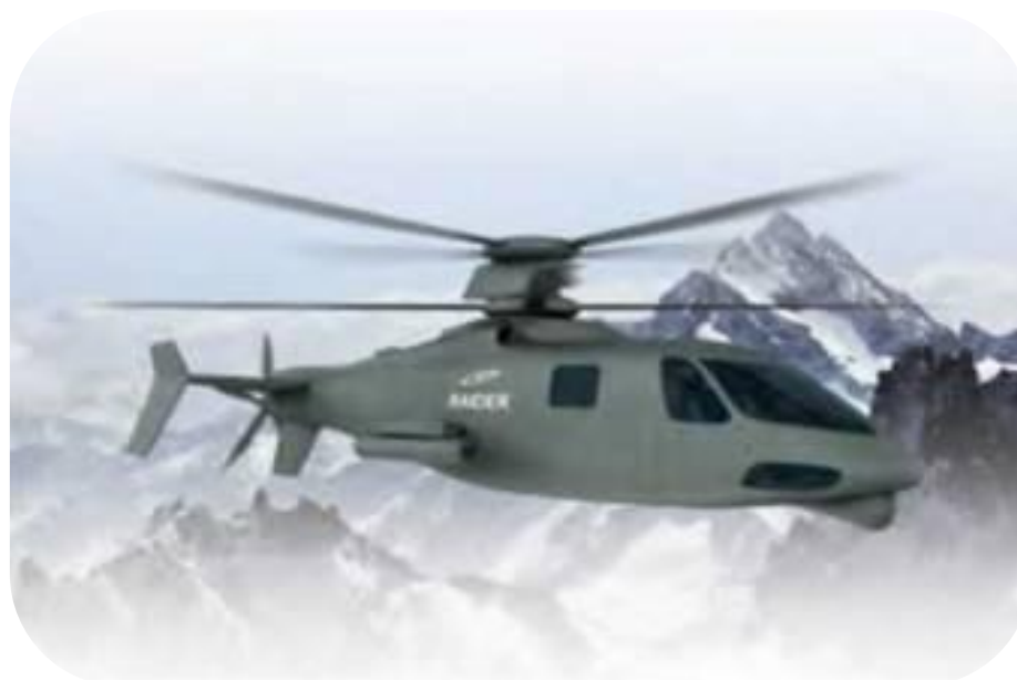
Sikorsky S-97 Raider (США, 2014). Пилотируемый и беспилотный винтокрыл. Максимальная скорость 490 км/ч.
