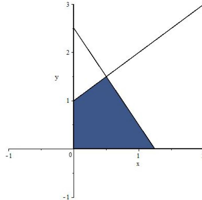
Пример 1. Решите графически задачу линейного программирования на максимум, если целевая функция  $Z(X) = 8x + 9y$ , а ограничения выражаются системой неравенств  $\{0 \leq x, 0 \leq y, 2y + 4x \leq 5, 7y - 7x \leq 7\}$
