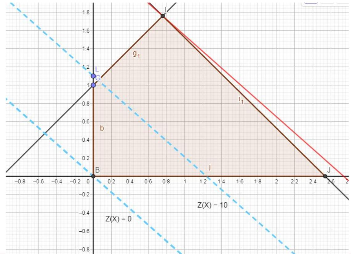
Пример 1. Решите графически задачу линейного программирования на максимум, если целевая функция  $Z(X) = 8x + 9y$ , а ограничения выражаются системой неравенств  $\{0 \leq x, 0 \leq y, 2y + 4x \leq 5, 7y - 7x \leq 7\}$
