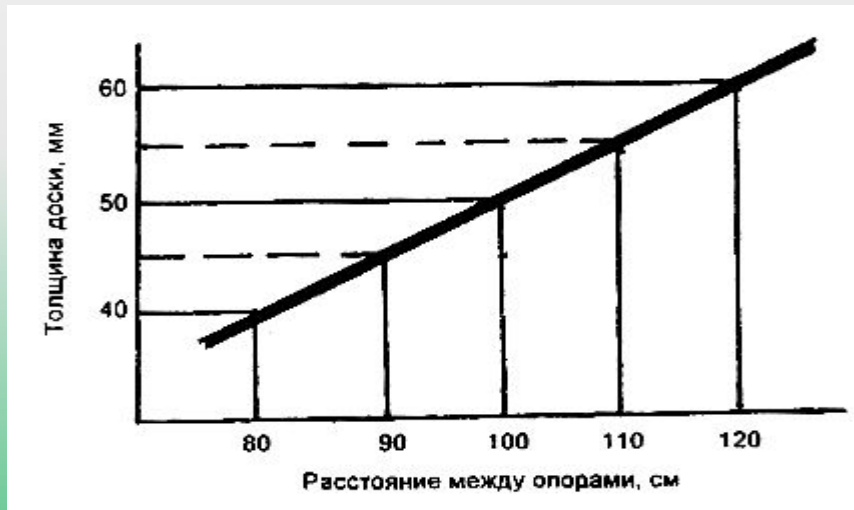
Рис.10. График зависимости толщины доски ступеней от расстояния между опорами.
