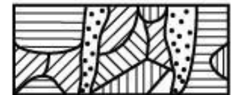
д) транскристаллитная коррозия
