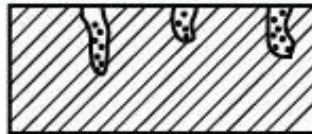
в) точечная коррозия
