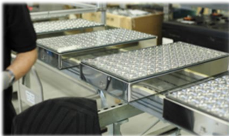
Сборочный конвейер ФЭМ
