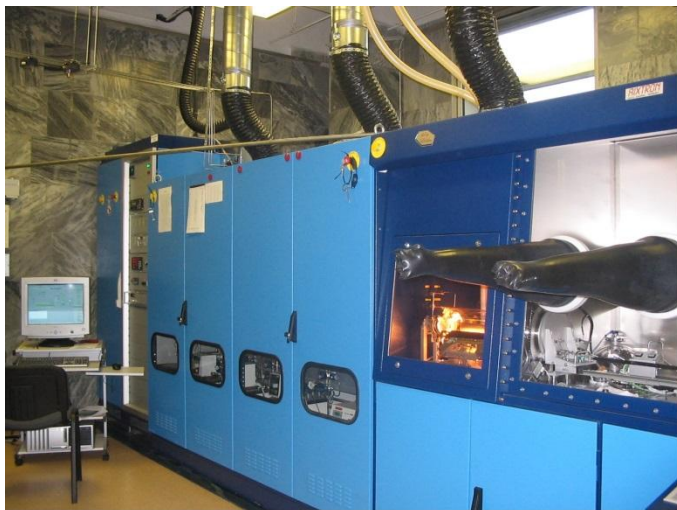
Установка МОС-гидридной эпитаксии для получения гетероструктур для каскадных солнечных элементов
