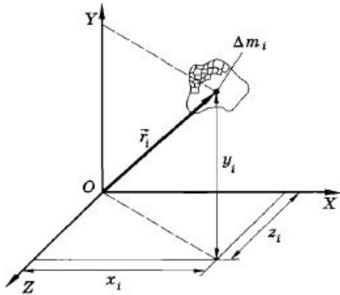
*Рис. 4 – Положение материальной точки в трехмерной системе координат*
