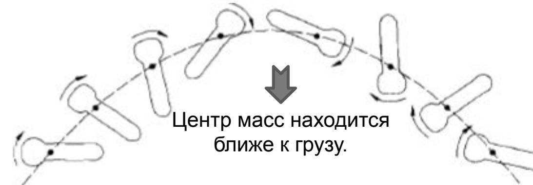
Рис. 2 – Траектория движения центра масс палки с грузом
