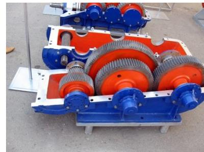
*Привод состоит из электродвигателя, редуктора, соединительных муфт, тормоза и приводного барабана (барабанов).*
