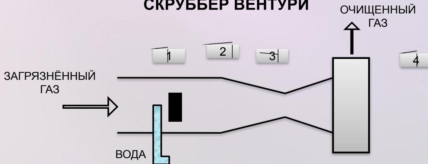
Основная часть скруббера — сопло Вентури 3. В конфузную часть 1 подается загрязненный газ. Через центробежные форсунки 2 подается жидкость на орошение.
