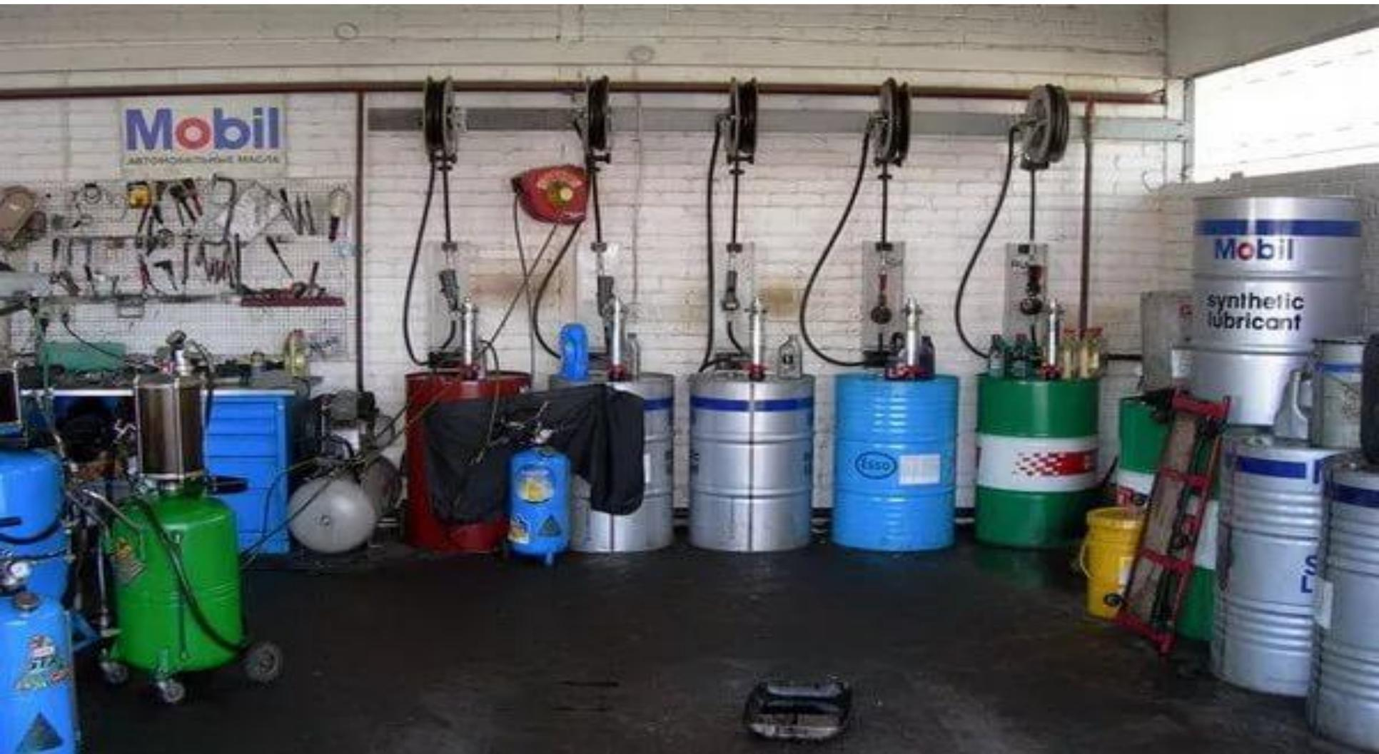
К маслораздагочному оборудованию для выдачи моторных масел относятся различные маслораздаточные баки, установки и маслораздаточные колонки
