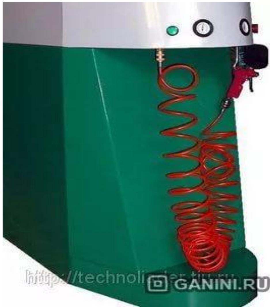
Современные колонки состоят из пульта и двух воздухораздаточных рукавов с наконечниками для подсоединения к вентилям шин
