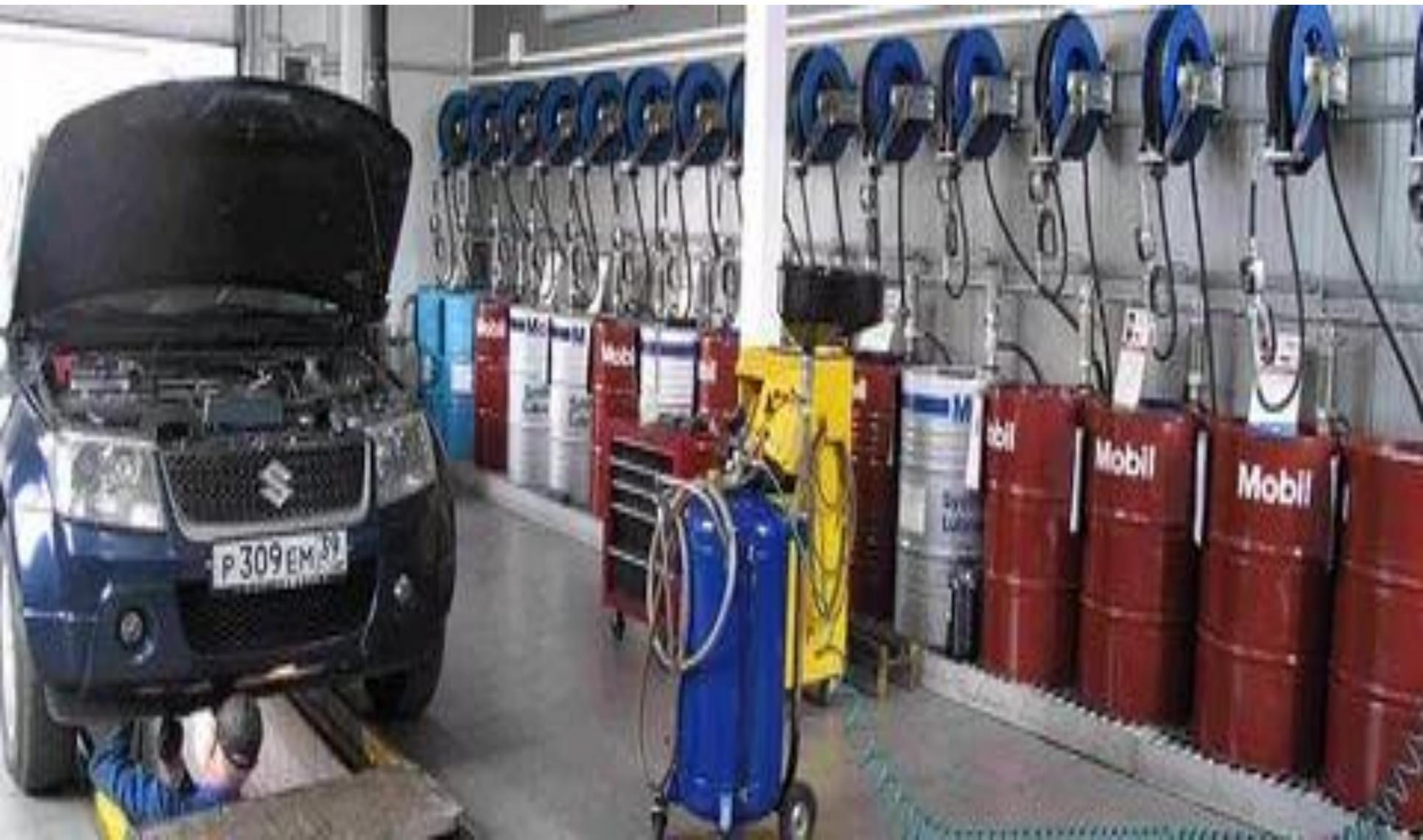
Для сбора отработавшего масла служат переносные и передвижные баки с воронками и стационарные сборники-резервуары, установленные под полом помещения с маслоприемными воронками
