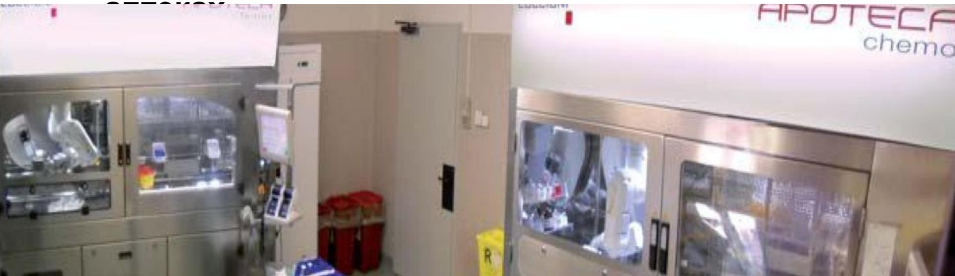
**APOTECFAchemo - автоматизированная система с роботом- манипулятором, готовящим противоопухолевые ЛС, минимизируя человеческий контакт с токсическими веществами (безопасность персонала).**
