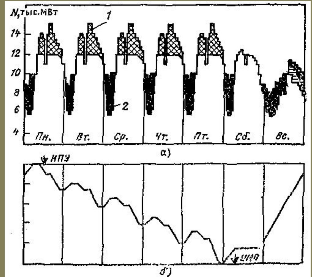
а) в графике нагрузки; б) изменение отметки уровня воды в верхнем бассейне; 1 – турбинный режим; 2 – насосный режим
