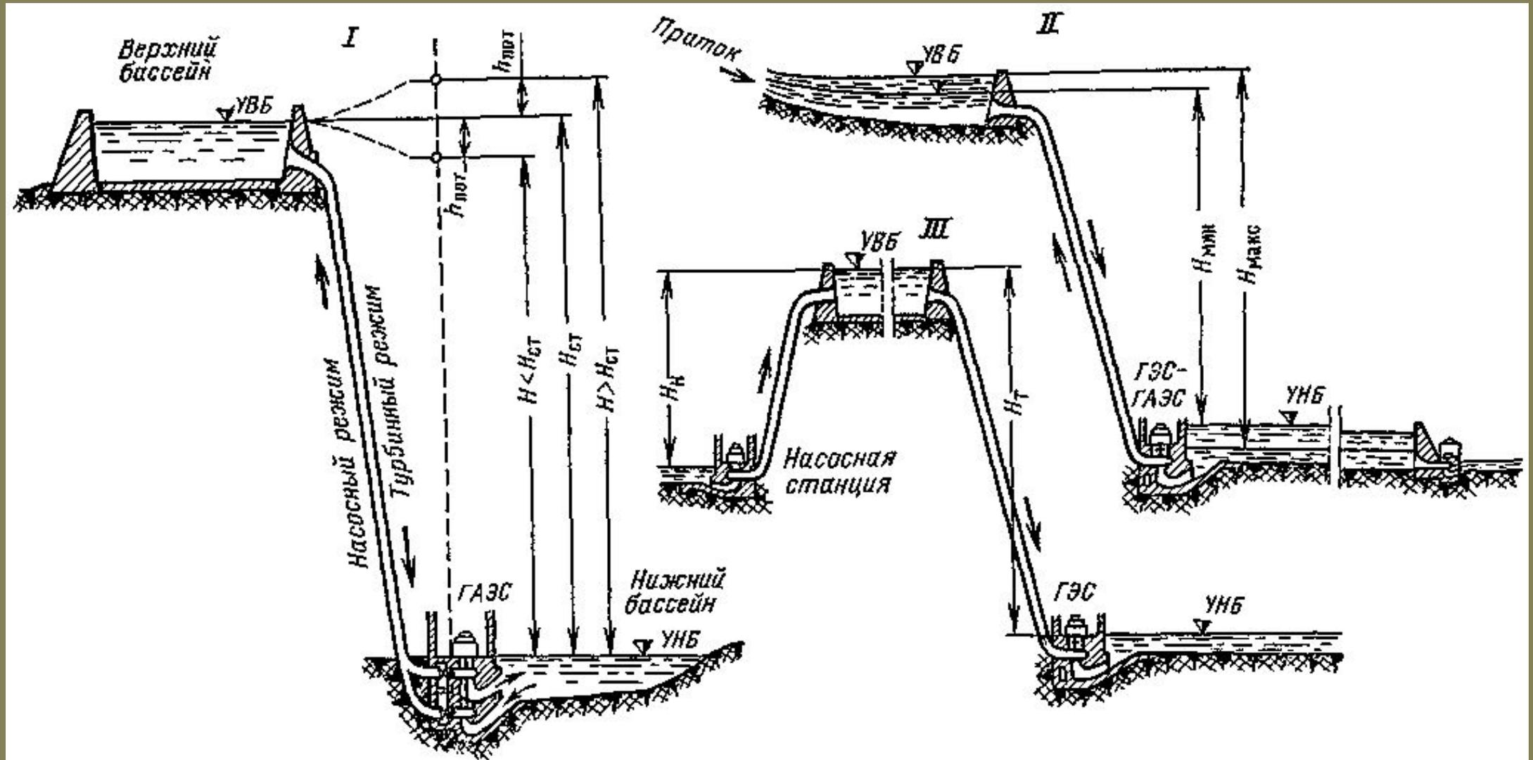
I – простого аккумулирования; II – ГЭС-ГАЭС; III- ГАЭС в схеме переброски стока или ГАЭС с неполной высотой подкачки в бассейн (канал) на водоразделе
