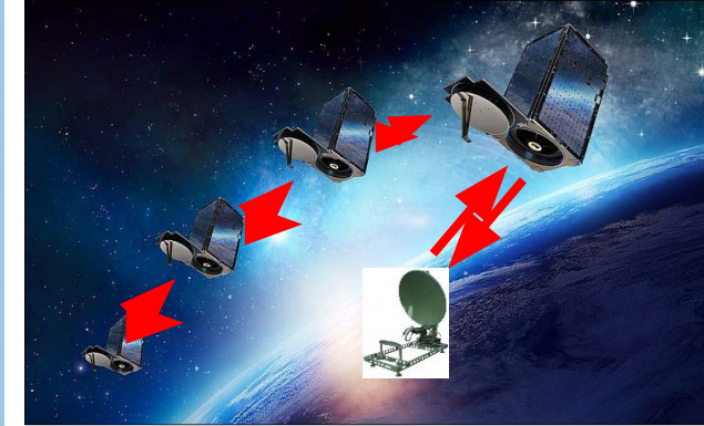
3. Сеанс связи – передача информации (синтезированного изображения) и освобождение бортового запоминающего устройства
