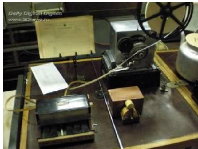
Аппарат Бодо-дуплекс. Для печати на пяти клавишах используются два пальца левой руки и три – правой
