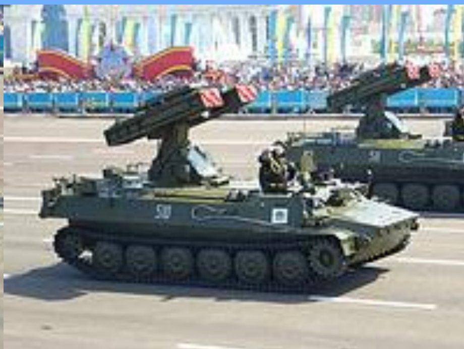
120-мм зенитно-ракетный комплекс «Стрела-10» Дальность пуска – до 5 км
