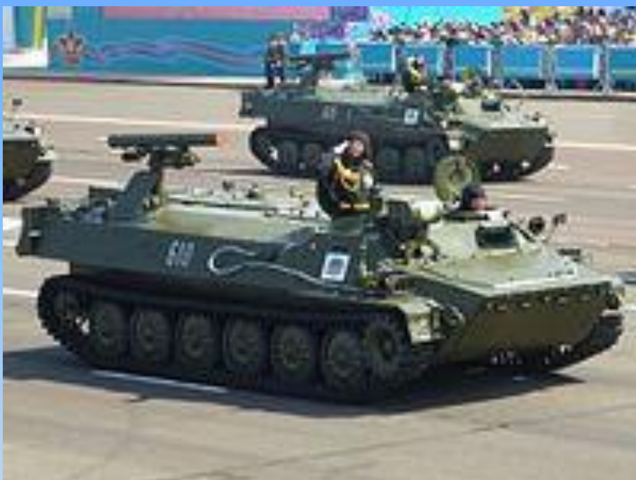
130-мм противотанковый ракетный комплекс «Штурм-С» Дальность стрельбы – до 5 км
