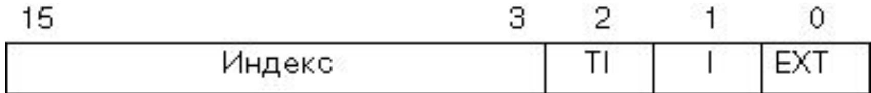
Поле индекса содержит индекс дескриптора, при обращении к которому произошла ошибка. Поле I, равное 1, означает, что этот индекс относится к таблице IDT. В этом случае произошла ошибка при обработке прерывания или исключения.
