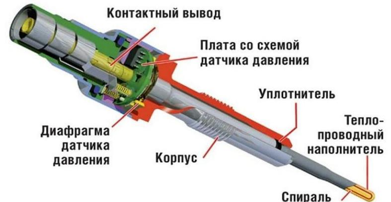
Самые современные свечи имеют встроенный датчик давления для контроля процесса сгорания смеси.
