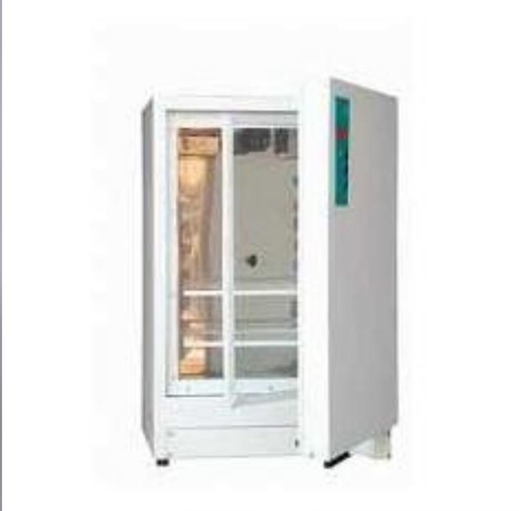
**Термостат**- это аппарат, в котором поддерживают постоянную температуру. Прибор состоит из нагревателя, камеры, двойных стенок, между которыми циркулирует воздух или вода. Температура регулируется терморегулятором. Оптимальная температура для размножения большинства микроорганизмов  $37^{\circ}\text{C}$
