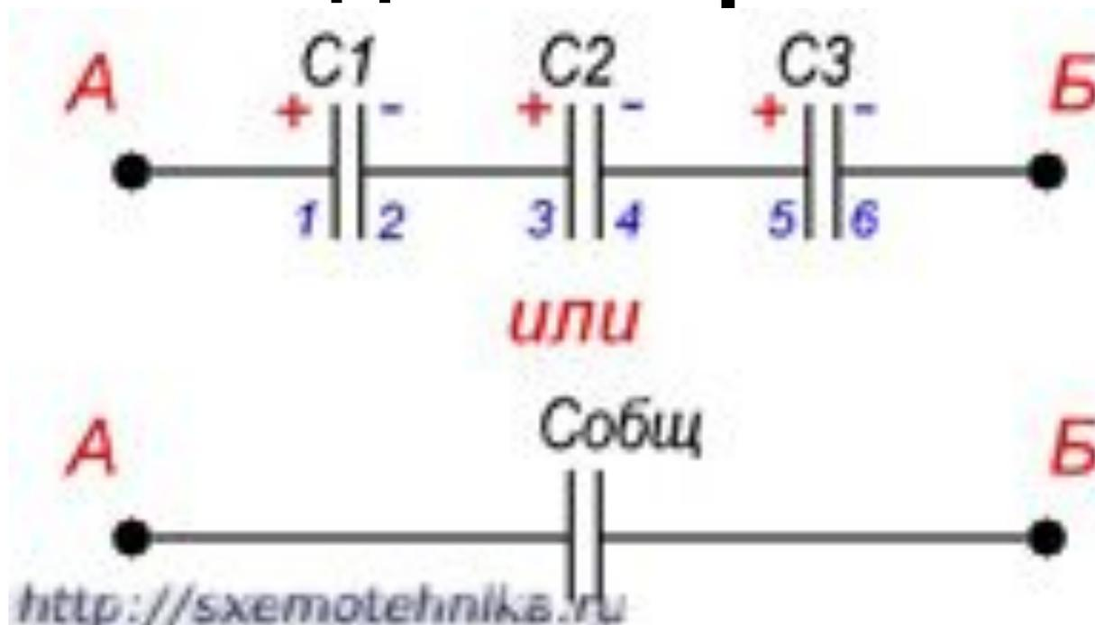
Если соединение конденсаторов в батарею производится в виде цепочки и к точкам включения в цепь непосредственно присоединены пластины только первого и последнего конденсаторов, то такое соединение конденсаторов называется **последо**
