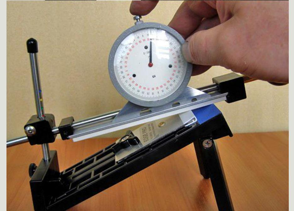
По точности считывания информации предпочтение отдается индикаторам с круглой шкалой, на втором месте – полукруглая шкала, на третьем – прямолинейная горизонтальная, на четвертом – прямолинейная вертикальная (за исключением приборов для контроля глубины, высоты, температуры – ассоциации мышления).
