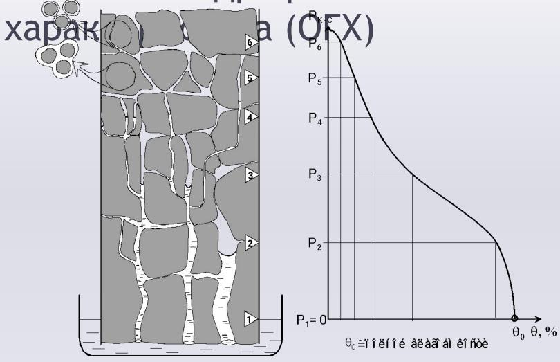
Основная гидрофизическая характеристика (ОГХ) — изотерминеская равновесная зависимость капиллярносорбционного (матричного) давления почвенной влаги от влажности почвы. Влажность почвы может быть выражена как в весовых, так и в объемных процентах (долях).
