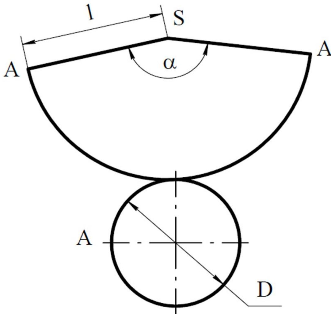
**Разверткой поверхности конуса вращения является сектор круга радиусом  $R = l$ , где  $l$  – образующая,  $\alpha = 2\pi r / l$  – угол сектора,**
