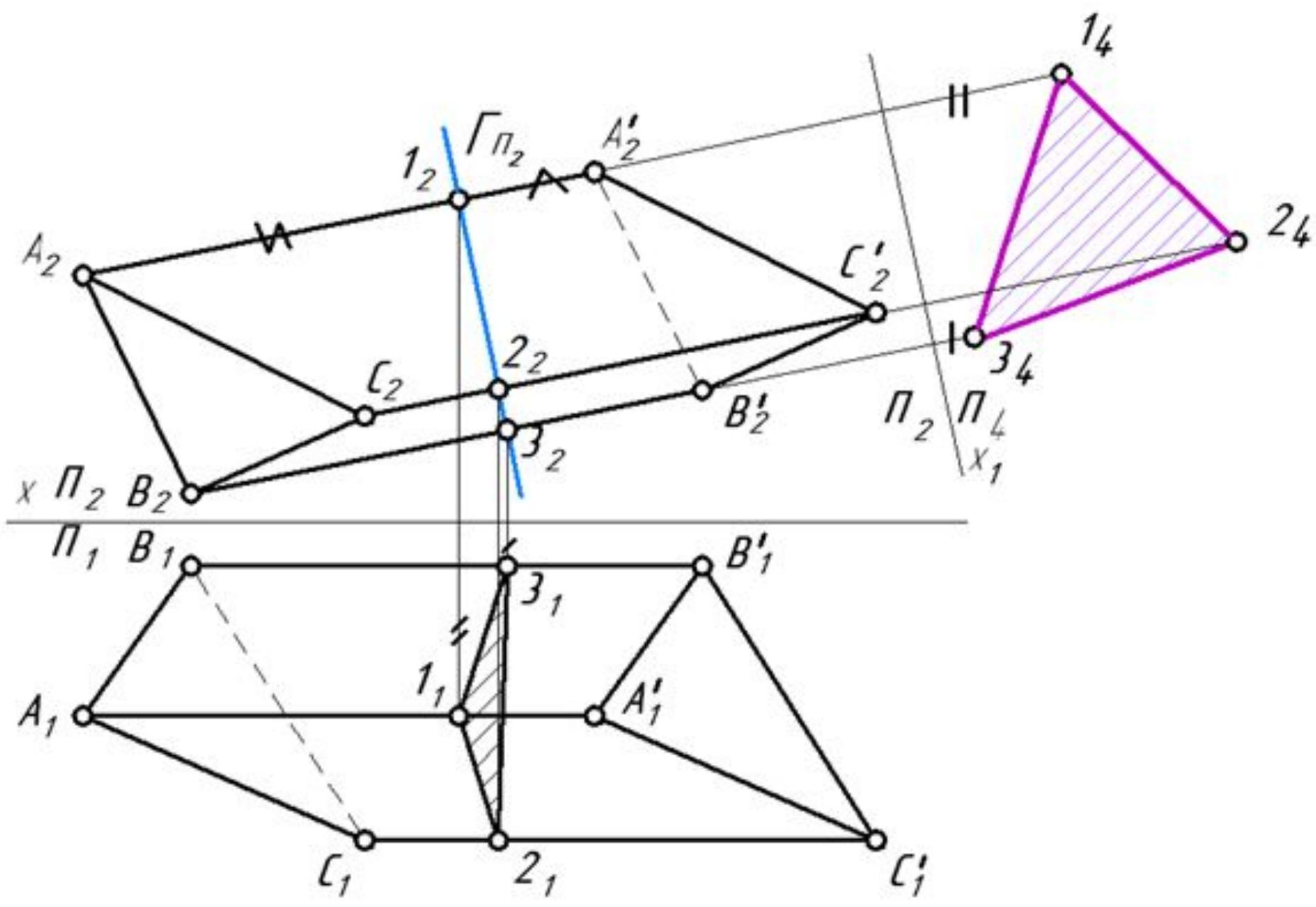
На свободном поле чертежа проводим горизонтальную прямую и последовательно откладываем на ней отрезки  $12=1_4 2_4$ ,  $23=2_4 3_4$ ,  $31=3_4 1_4$ . Из точек 1, 2 и 3 строим перпендикулярные линии 1-1 прямые.
