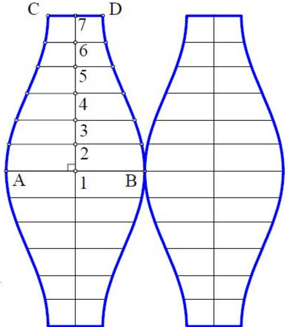
Развёртку конуса вращения с криволинейной образующей получаем разбивкой на ряд описанных конусов. Точные развертки этих получаем, используя формулы углов соответствующих секторов:  $\alpha = 2\pi r/R$ , где  $r$  принимает значения  $r_1, r_2, r_3$ ;  $R$  принимает значения  $S^1C, S^2C, S^2B, S^3B, S^3A$
