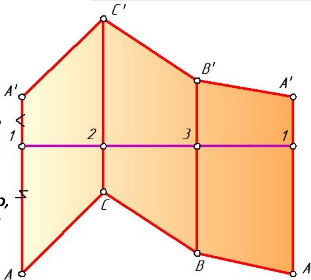
**Построение развертки поверхности трехгранной наклонной призмы способом нормального сечения.**
