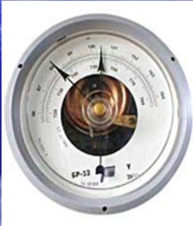
Внешний вид барометра - анероида
