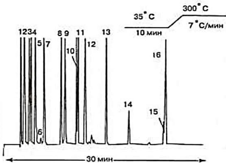
*Хроматограмма меркаптанов, полученная на капиллярной колонке с поперечношитым метилсиликоном с пламенно - фотометрическим детектором*
