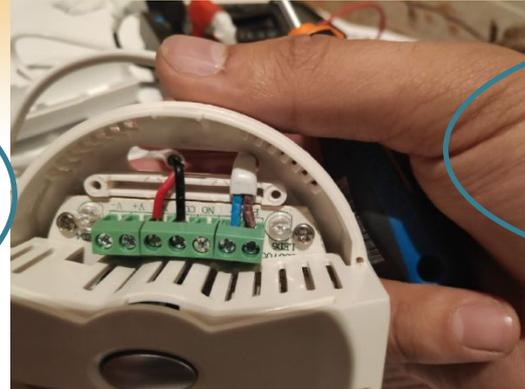
2. Подключаем кабель в разъемы COM и NC.
