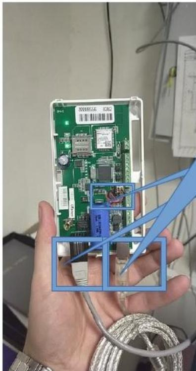
1. Подключаем элемент питания внутри ХАБа
