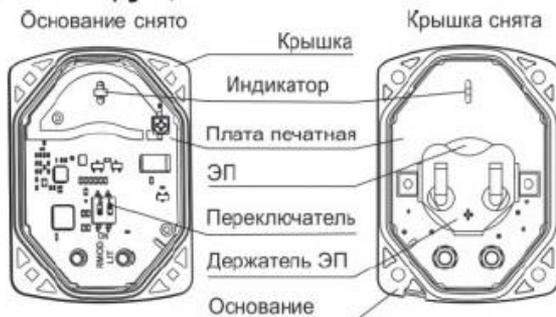
Извещатель разместить на полу в **наиболее низком** месте помещения, где необходимо контролировать возможность затопления (с учетом направления стока воды в случае прорыва водопровода или системы отопления).
