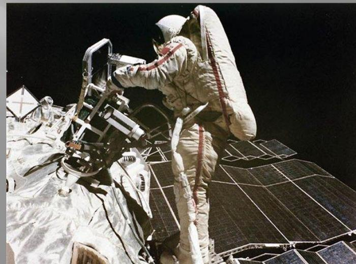
В период с 1979 по 1984 г. в космосе проводились эксперименты по нанесению тонкопленочных металлических покрытий на образцы из конструкционных сталей методом термического испарения и конденсации. Они проводились на установках типа «Испаритель», оснащенных двумя электронно-лучевыми пушками.
