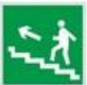
E 16 Направление к эвакуационному выходу по лестнице вверх (левосторонний)
