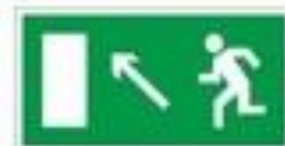
E 06 Направление к эвакуационному выходу налево вверх
