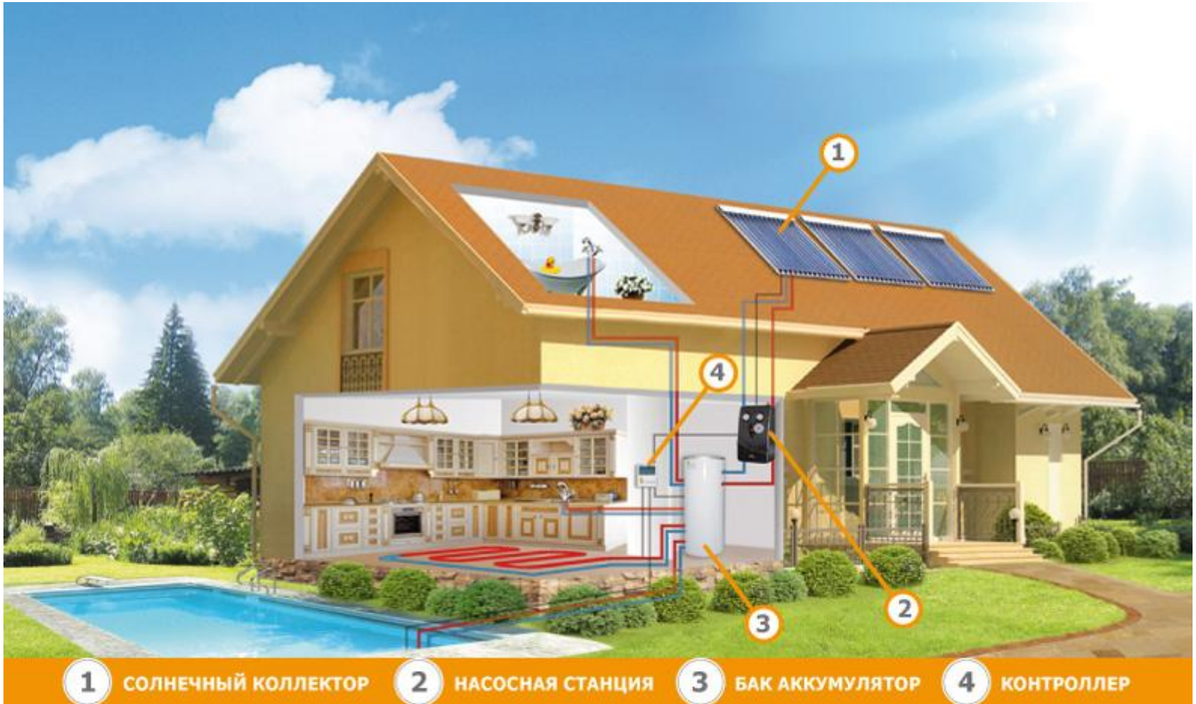
Рис. 4. Инженерное оборудование. Устройство подогрева воды. Теплый пол
