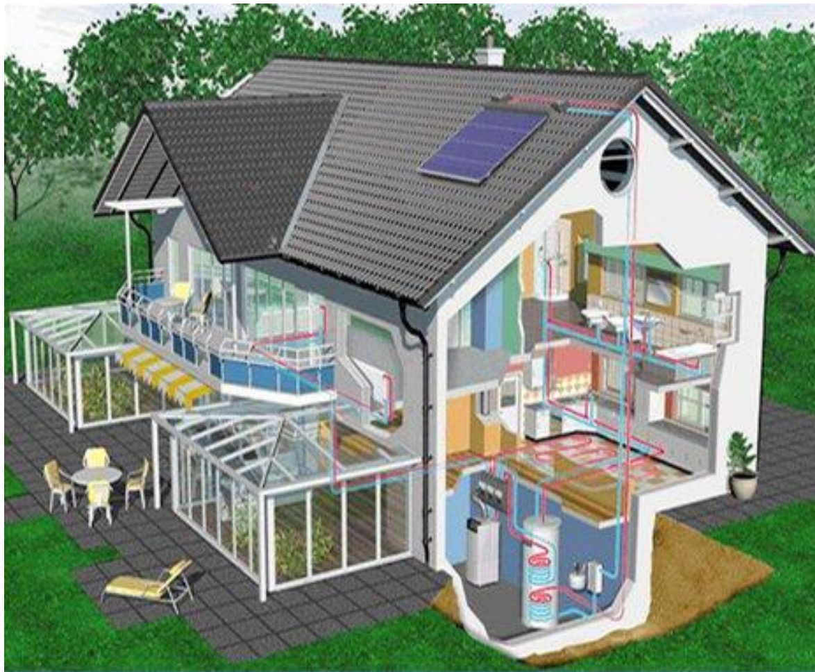
Рис. 3. Инженерное оборудование. Устройство подогрева воды
