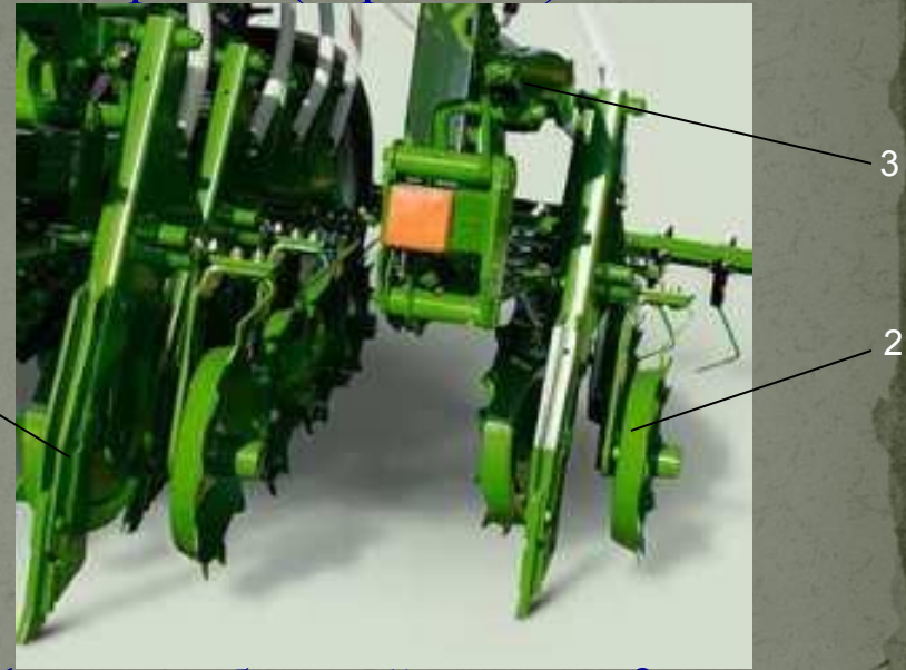
1-долотообразный сошник; 2-каток; 3-параллелограммный механизм
