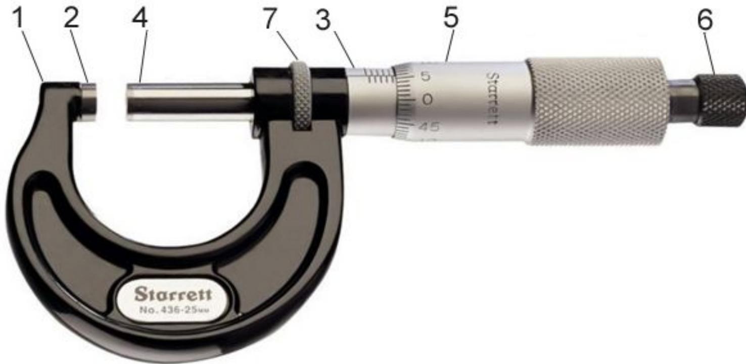
Микрометр состоит из **стальной скобы 1**, которая с одной стороны имеет неподвижную **пятку 2** с измерительной поверхностью, а с другой – **стебель 3**, в котором закреплена гильза с внутренней резьбой. В гильзе ходит микрометрический винт (**шпиндель 4**) с шагом 0,5 мм; на левом конце винт заканчивается измерительной поверхностью. Снаружи стебель охватывается **барабаном 5**, соединенным с **микрометрическим винтом 4**. При вращении барабана вращается и винт.
