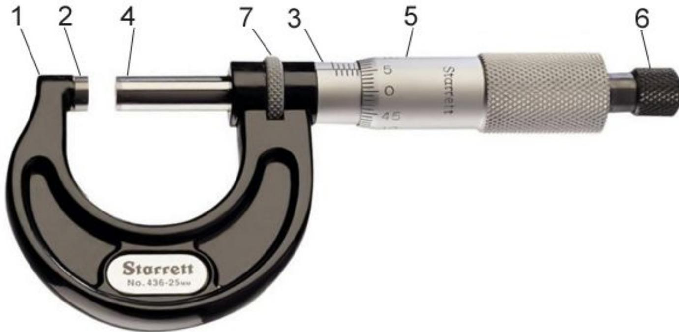
Измеряемый предмет помещают между измерительными поверхностями **пятки 2** и **винта 4**. Для того, чтобы при перемещении винта не могло произойти сильного сжатия предмета, на правом конце барабана имеется **предохранительная головка 6 с трещоткой**. При ее вращении устраняется главный источник ошибок – неравномерный нажим винта на измеряемый предмет. Услышав звук трещотки, прекращают вращение головки 6, закрепляют поворотом зажимного кольца (**стопор 7**) шпиндель и производят отсчет.
