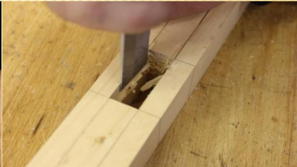
Так как у нас сквозное соединение то значит, что гнездо нужно продалбливать с двух сторон на встречу друг другу. Это значит, что при долблении гнезда с одной стороны доходим до середины заготовки, затем переворачиваем заготовку и повторяем все действия сначала
