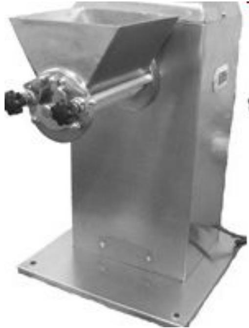
используется для сухого и влажного гранулирования порошковых масс в фармацевтическом производстве.
