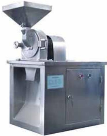
Применяется при работе с термостабильными веществами, обладающими плохой сыпучестью. В основе работы - движение материала с высокой скорости между подвижными зубами и фиксированными зубцами, что позволяет измельчить вещества путем удара и трения. Размер гранулята корректируется путем смены сит с различной шириной отверстий. Размолотое вещество автоматически поставляется в улавливатели путем выдувания, пыли собирается в фильтре и затем в емкости абсорбирующей пыль.
