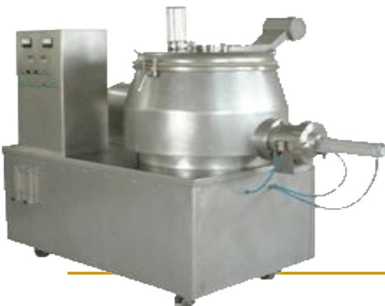
Гранулят на выходе из вертикальных грануляторов компактен, с хорошей сыпучестью, поскольку при грануляции происходит механическое уплотнение продукта.
