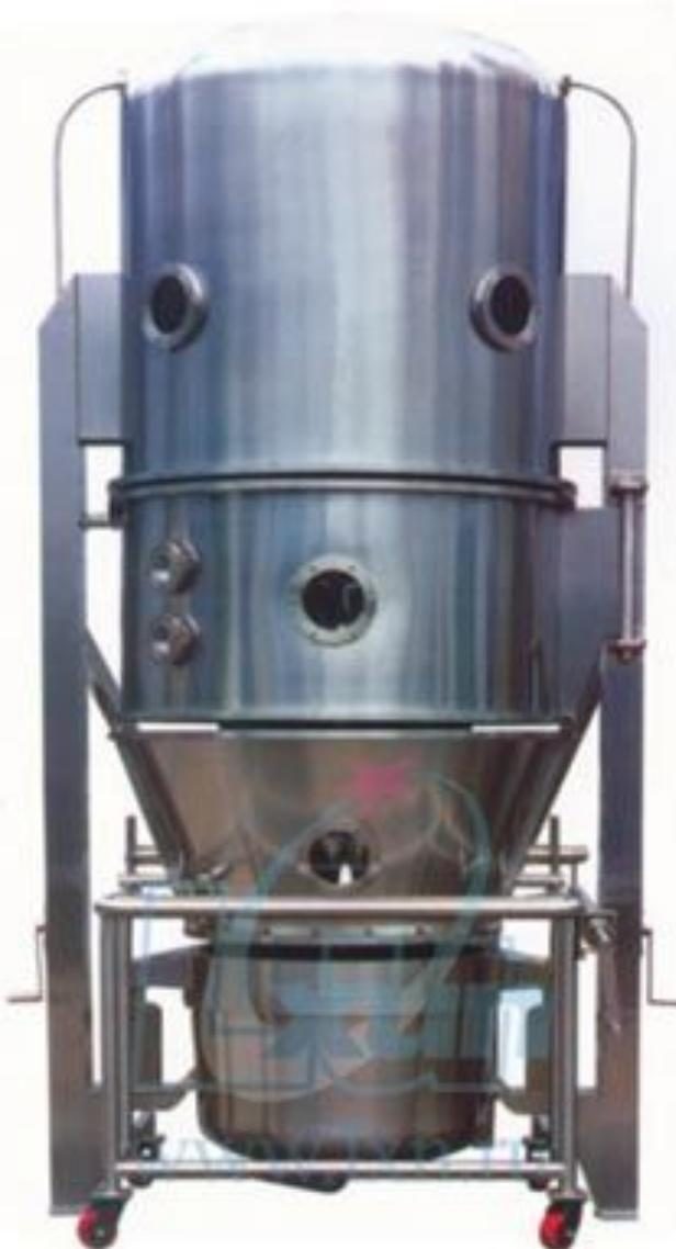
Предназначена для сухого смешивания порошков в емкости, впрыскивания связующей жидкости через форсунки, последующего гранулирования и сушки многокомпонентных таблетсмесей в кипящем слое.
