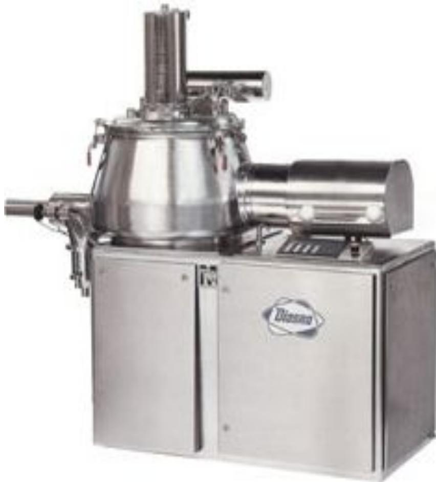
Миксер Р 100 и Р 150 для разработан специально для фармацевтической промышленности, для эффективного перемешивания и влажного гранулирования массы для таблетирования.
