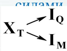
Разность температур  $X_T$  в тепловой системе создает поток тепла  $I_Q$  и поток вещества  $I_M$
