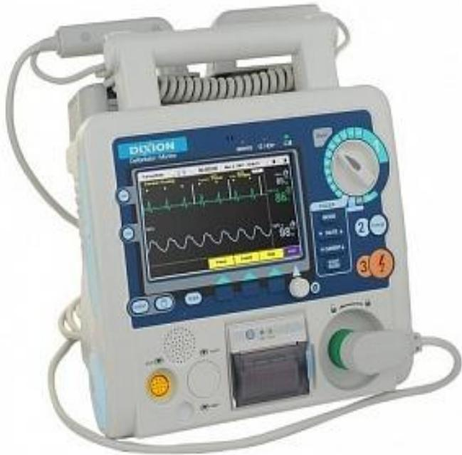
представляет собой портативное электронное устройство, которое автоматически диагностирует потенциально опасные для жизни нарушения ритма сердца: ФЖ и желудочковую тахикардию – и может купировать жизнеугрожающую аритмию при помощи подачи электрического разряда.
