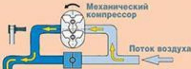
До 2500 об/мин перепускная заслонка закрыта. Эффективно работать может только механический компрессор.
