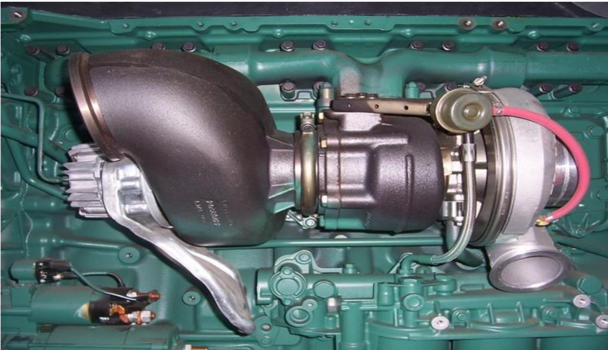
После продолжительного движения на высокой скорости автомобиля с турбонаддувом турбина может раскрутиться до высоких скоростей (сотни тысяч оборотов в минуту)
