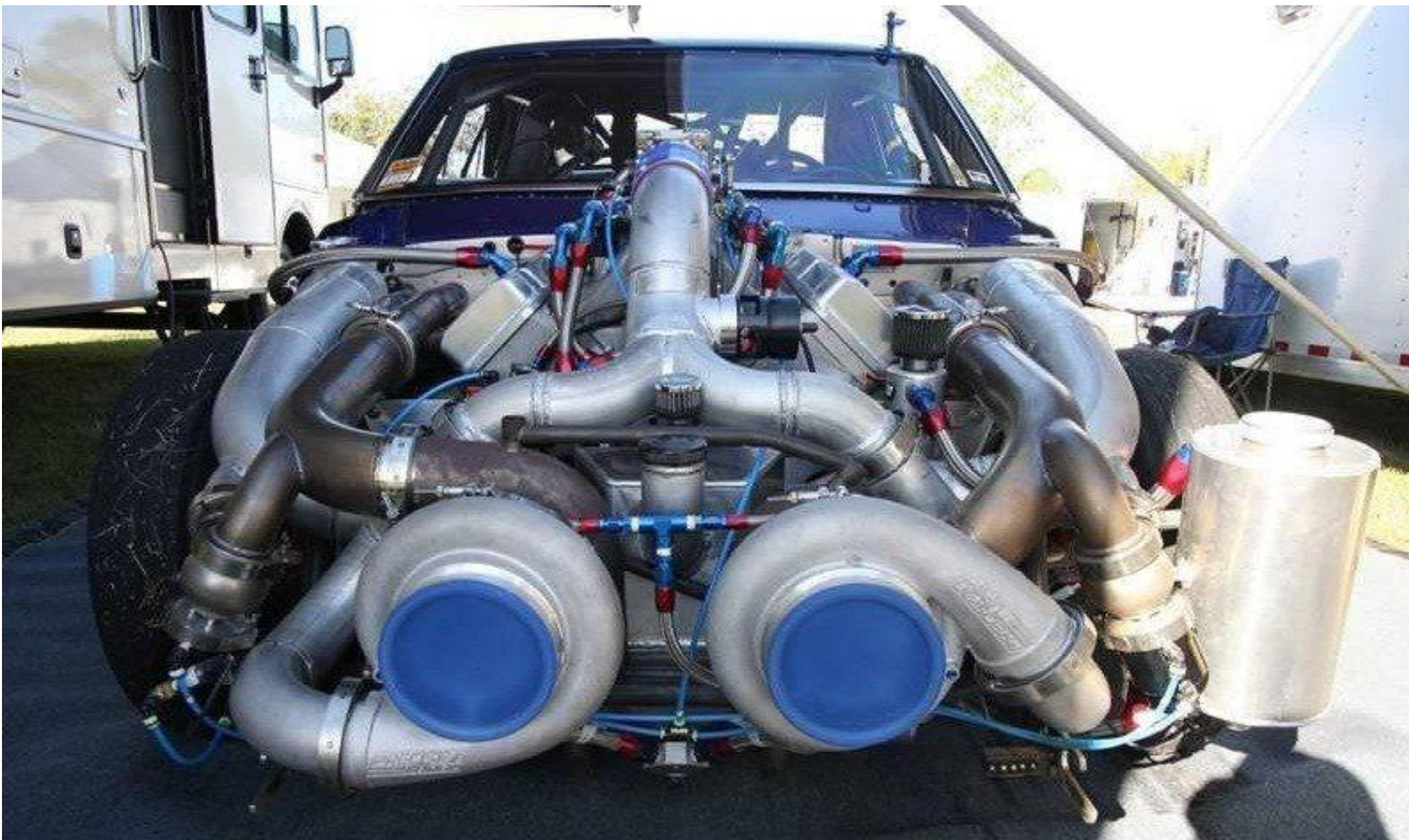
При малых оборотах двигателя турбокомпрессор работает в дежурном режиме (частота 5 000-10 000 мин<sup>-1</sup>). Необходимо учитывать, что наличие турбины в выпускном тракте создает сопротивление выходу отработавших газов
